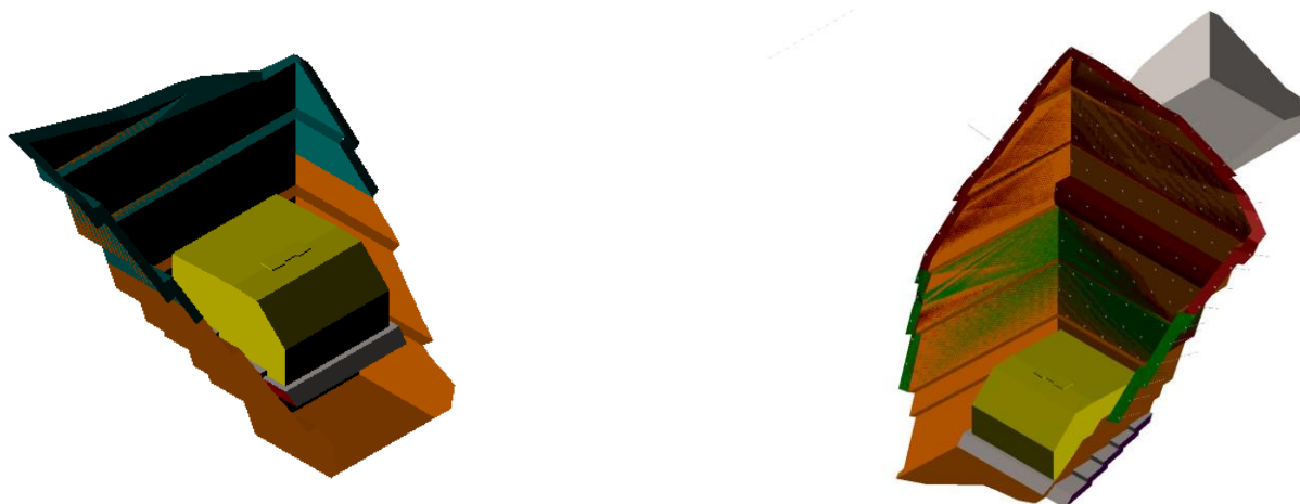
Obrázek 5: tvar stavební jámy P3 a P9 aktualizovaný včetně zajištění rastrem tyčových horninových kotev, je naznačeno i spojení s jámou P2, která bude po výstavbě zasypána
